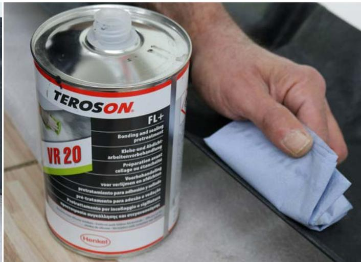
8. Kleber auf die abgeschliffenen und gesäuberten Stellen des Heckdiffusors auftragen
