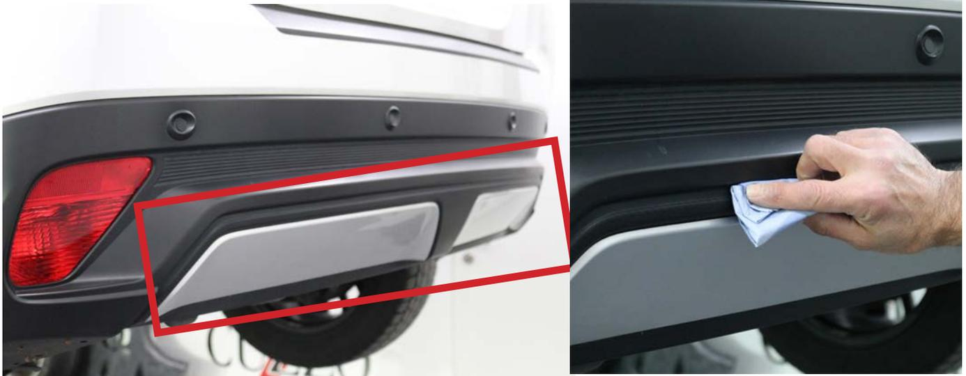
4. Primer auf die Anlagefläche am Fahrzeug auftragen
