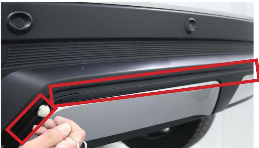
7. Zwischenzeitlich den Heckdiffusor mit einem Schmirgelpapier um den inneren Rand abschleifen, danach säubern
