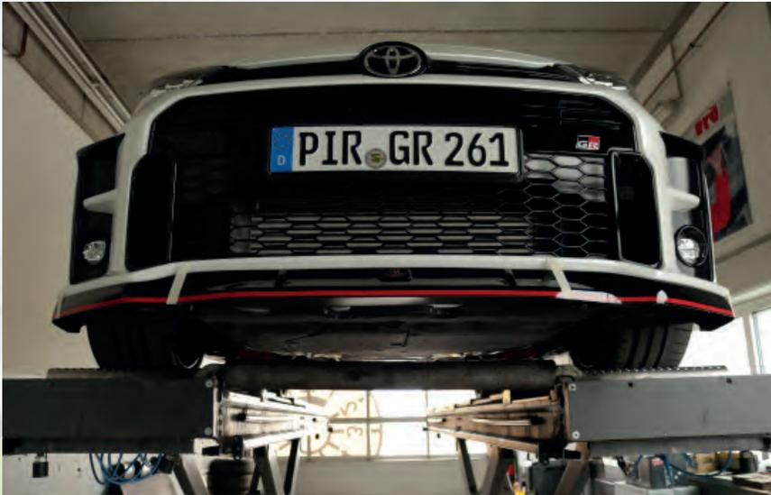
8. Die gelösten Schrauben wieder am Unterboden befestigen
