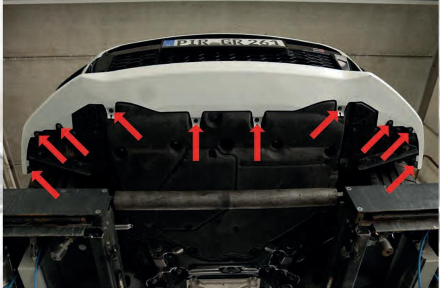
3. Lösen Sie die auf der Abbildung markierten Schrauben
