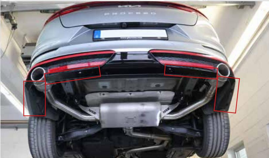
5. Die Anlageflächen des Heck-Diffusors mit Kleber benetzen
