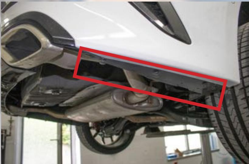
4. Befestigungs-Klipse am Fahrzeug beidseitig entfernen
