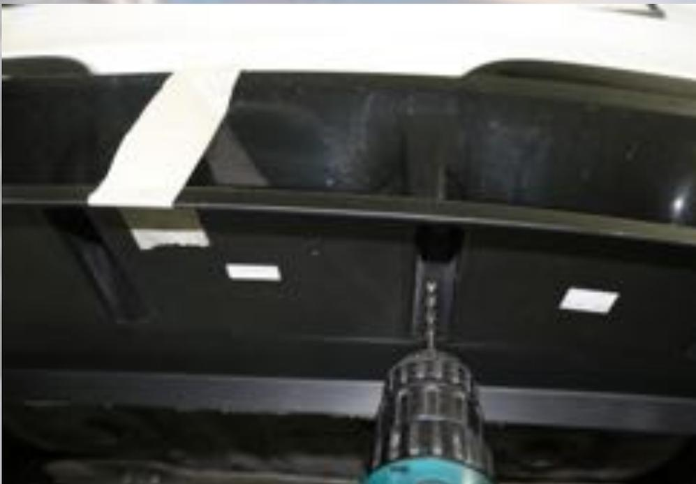
9. Beigelegte Blechschrauben zur weiteren Befestigung - mit Hilfe eines Akkuschaubers - nutzen (Stellen am Teil bereits vorgebohrt) - auf der Innenseite des Heck-Diffusors jede Blechschraube mit einer Blechmutter fixieren und Klebeband entfernen
