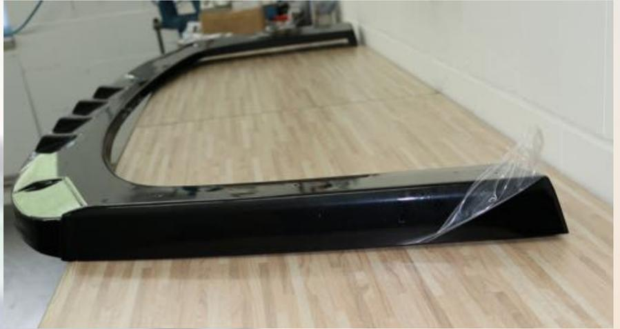
3. Heck-Diffusor und Anlagefläche (beidseitig) am Fahrzeug mit einem Reiniger zur Entfettung von Oberflächen (z.B. Teroson VR20) säubern
