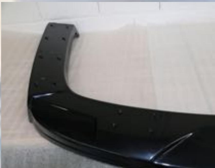
6. Heck-Diffusor am Fahrzeug anbringen und mithilfe der Befestigungs-Klipse fixieren
