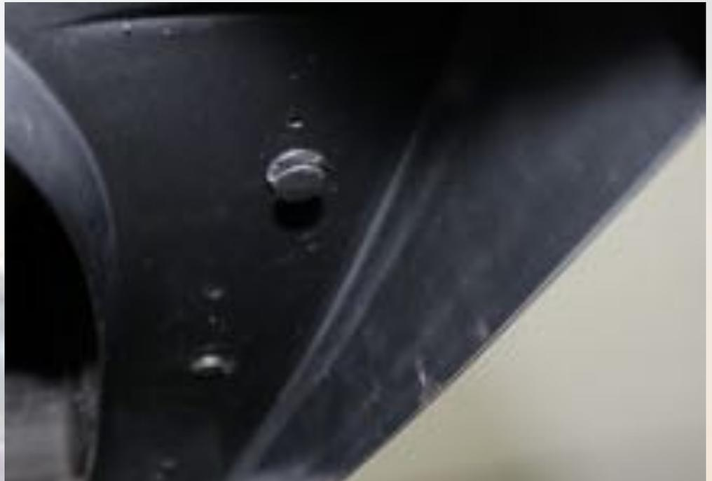
8. Mit einem 4 mm Bohrer durch die bereits vorhandenen Löcher im Heck-Diffusor bohren (12 Stück)
