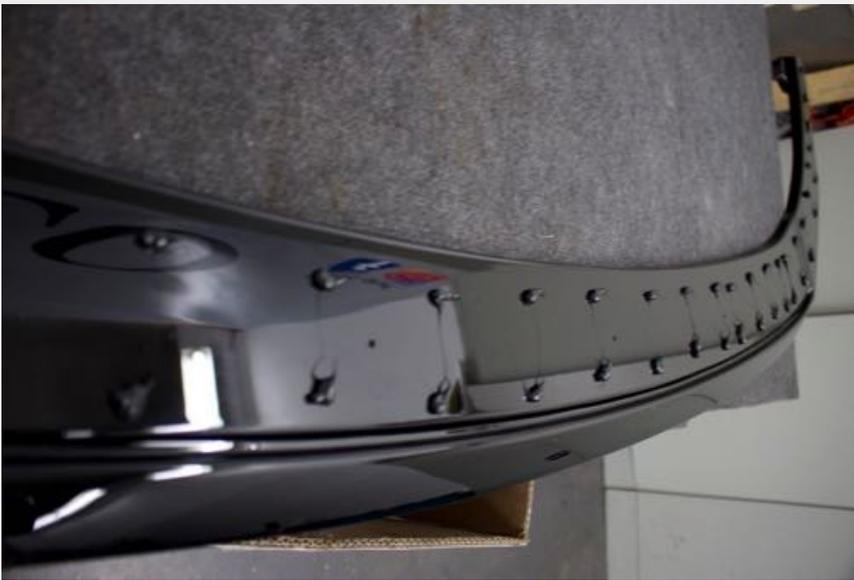
7. Beigelegte Blechschrauben zur weiteren Befestigung - mit Hilfe eines Akkuschaubers - nutzen (Stellen am Teil bereits vorgebohrt)
