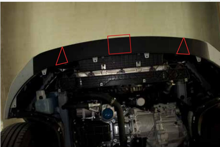
6. Die Anlageflächen des Spoilers mit Kleber benetzen
