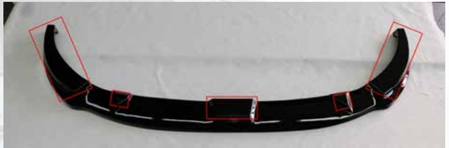
4. Markierte Fläche mit 3M Adhesion Promoter behandeln, sowie die Frontspoiler-Lippe an der Anlagefläche mit dem Primer-Sticks behandeln.
