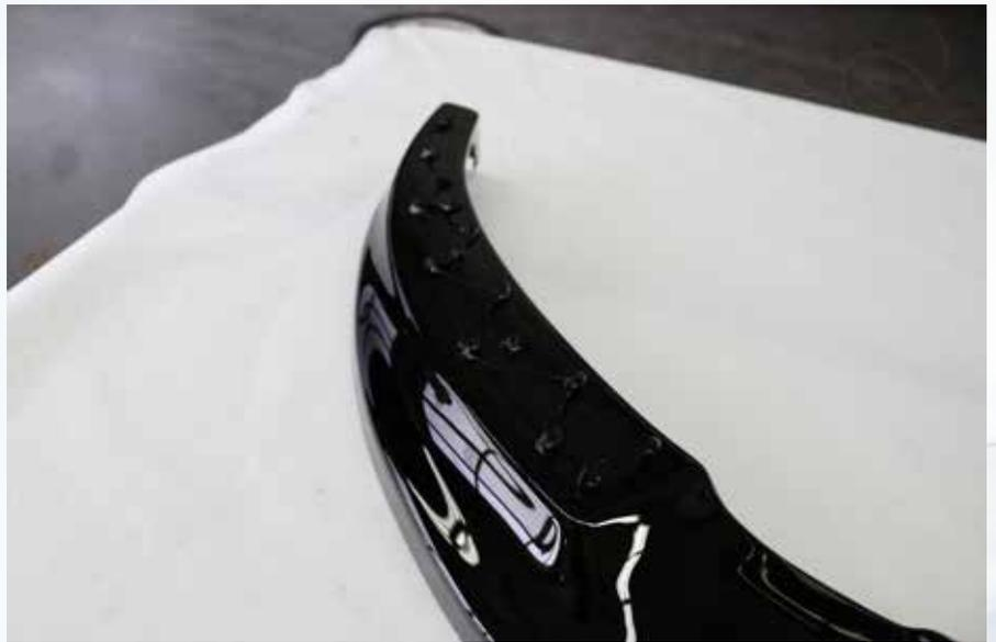
7. Beigelegte Blechschrauben zur weiteren Befestigung - mit Hilfe eines Akkuschaubers - nutzen (Stellen am Teil bereits vorgebohrt)
