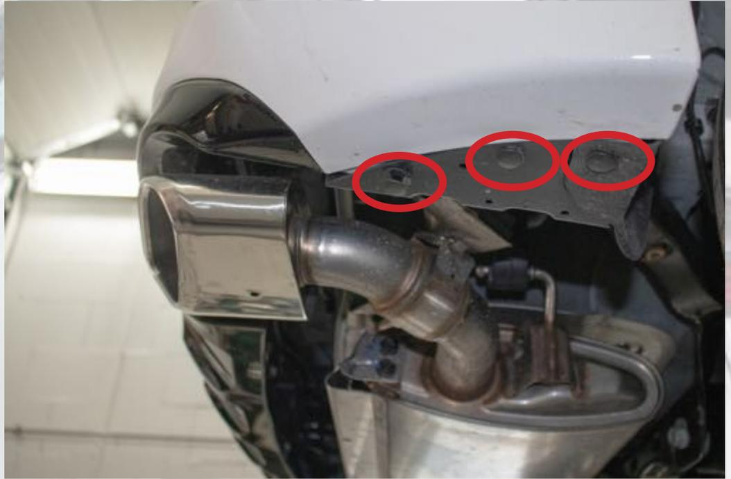
5. Heck-Diffusor am Fahrzeug anbringen und mithilfe der Befestigungs-Klipse fixieren
