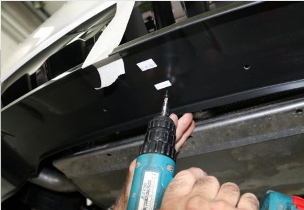
8. Beigelegte Blechschrauben zur weiteren Befestigung - mit Hilfe eines Akkuschraubers - nutzen (Stellen am Teil bereits durchbohrt)
