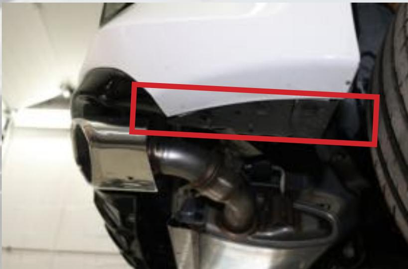
4. Befestigungs-Klipse am Fahrzeug beidseitig entfernen
