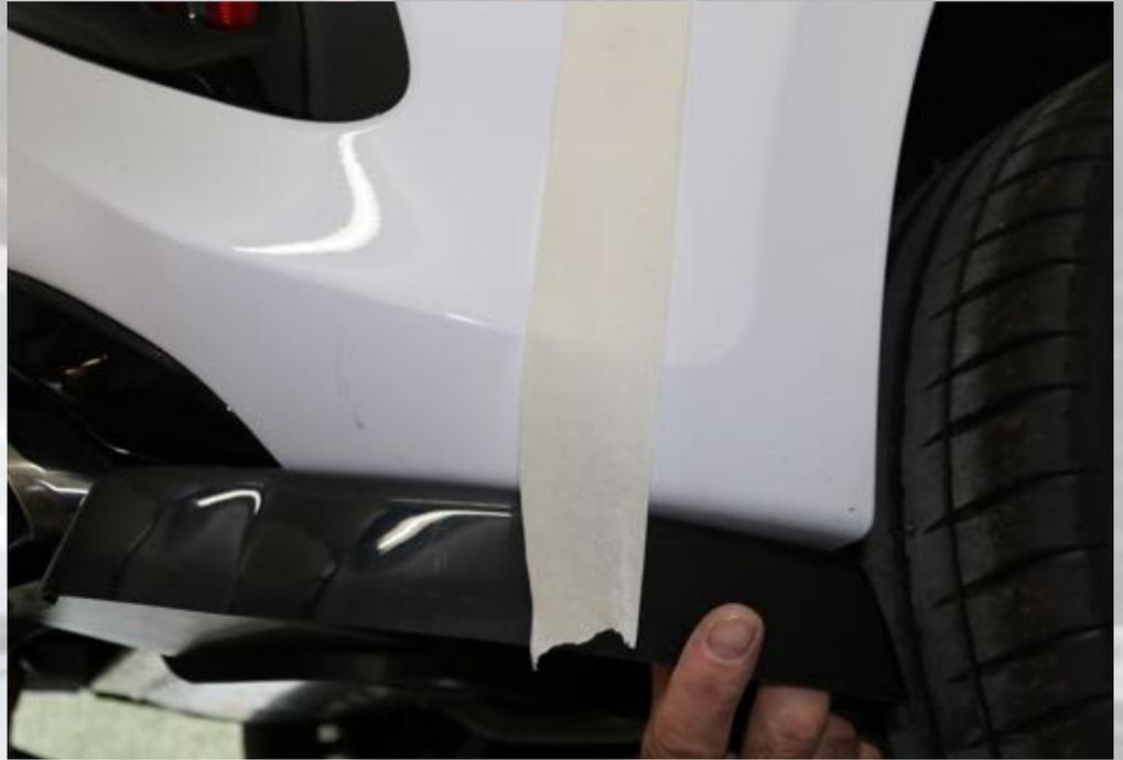
7. Mit einem 4 mm Bohrer durch die bereits vorhandenen Löcher im Heck-Diffusor bohren (9 Stück)
